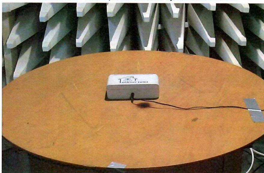
Obrázek 2.A – EUT v průběhu měření vyzařovaného rušení
