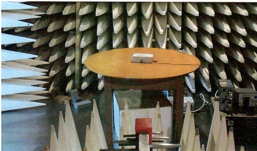
Obrázek 3.2.A – EUT během zkoušek odolnosti proti elektromagnetickému poli
